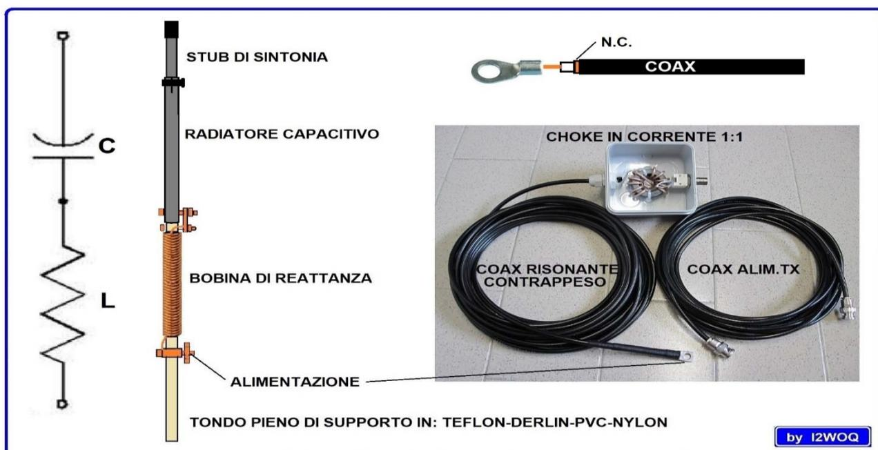
**CONFORMAZIONE DI MASSIMA ELETTRICO-PRATICO ANTENNA**
