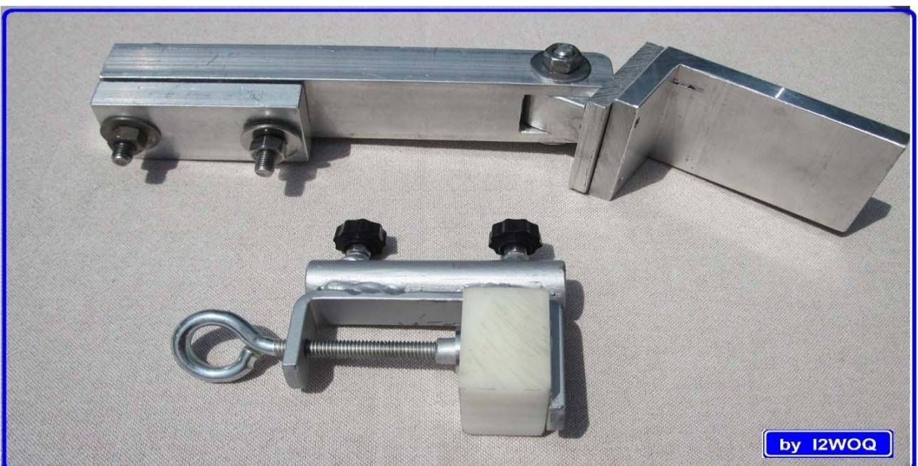
**STAFFA SNODATA E MORSETTO DI FISSAGGIO ANTENNA**
