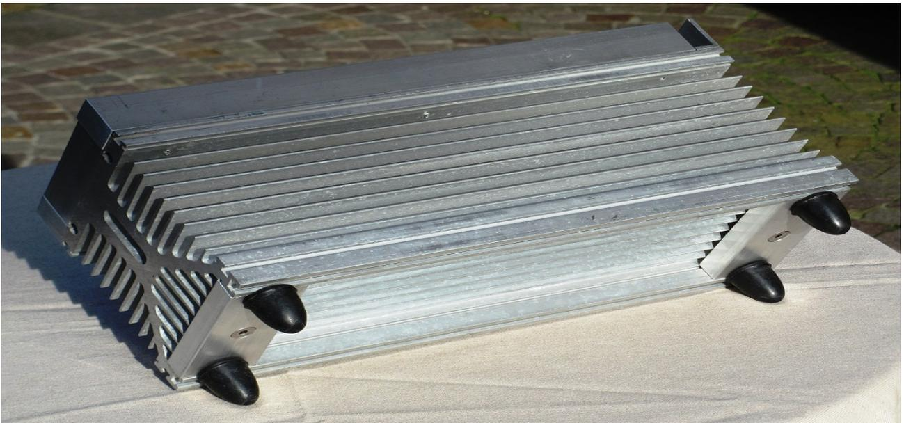
Per proteggere e schermare il vano superiore dove è installata la resistenza, ma anche per favorire lo scambio termico sviluppato dal chip, ho predisposto una griglia forata avvitata al dissipatore.
