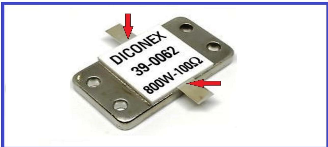
Prima di fissare la resistenza sul dissipatore come da prassi adottata anche per i transistor di potenza RF, la flangia d'appoggio deve essere cosparsa da un leggero strato di pasta termo conduttiva ad alta conducibilità termica.
